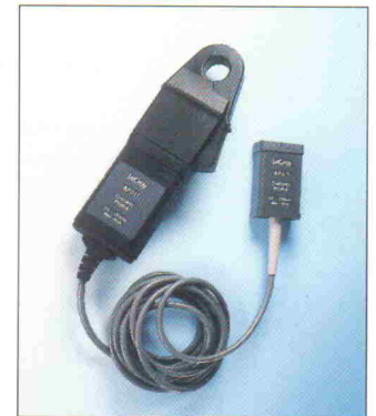
Bild 10. Die brandneue Stromsonde AP011 von LeCroy erfäßt Ströme von 0...150 A im Frequenzbereich von 0...120 kHz. Der Systemanschluß PROBus von LeCroy versorgt den Tastkopf mit Strom und sorgt für die richtige Skalierung.
