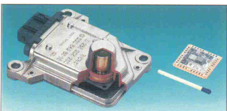
Bild 3. Vorher/nachher – FDR-Drehratensensor von Bosch.
