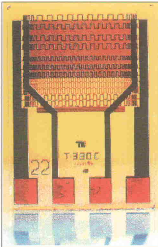
Bild 8. Mikro mit Grill – Chemosensor mit IDC und Heizelement vom MAT, TU Berlin.
