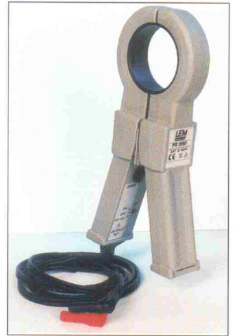
Bild 9. Ströme von bis zu 2000 A sind per Shunt nicht mehr erfäßbar – eine Aufgabe für eine Stromzange wie die PR-2000 von LEM (AC/DC, Auflösung 100 mA, Frequenzgang 0...10 kHz).
